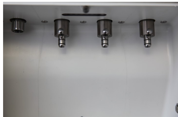
Bild 18 – iCare+ C3: koppling för 3 vinkelstycken
